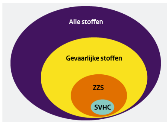
Figuur 1 Een overzicht van de verschillende groepen stoffen die onderdeel maken van het geheel aan chemische stoffen. SVHC (Substances of Very High Concern) zijn onderdeel van de groep ZZS (Zeer Zorgwekkende Stoffen). ZZS maken op hun beurt weer deel uit van de groep gevaarlijke stoffen.
